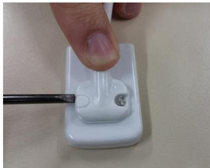
Con el destornillador con punta 3 x 0,8 mm remover los tornillos de fijación del cable.
