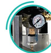
**Reservatório e filtro da saída:** elimina a umidade e impurezas restantes no ar. A umidade retirada na saída fica armazenada no reservatório e sua manutenção é de fácil acesso.
